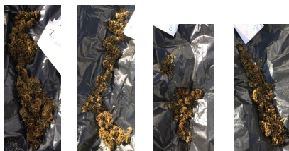
Kuva 2. Semes- ja Wile-kairoilla otettujen näytteiden vertailu.
