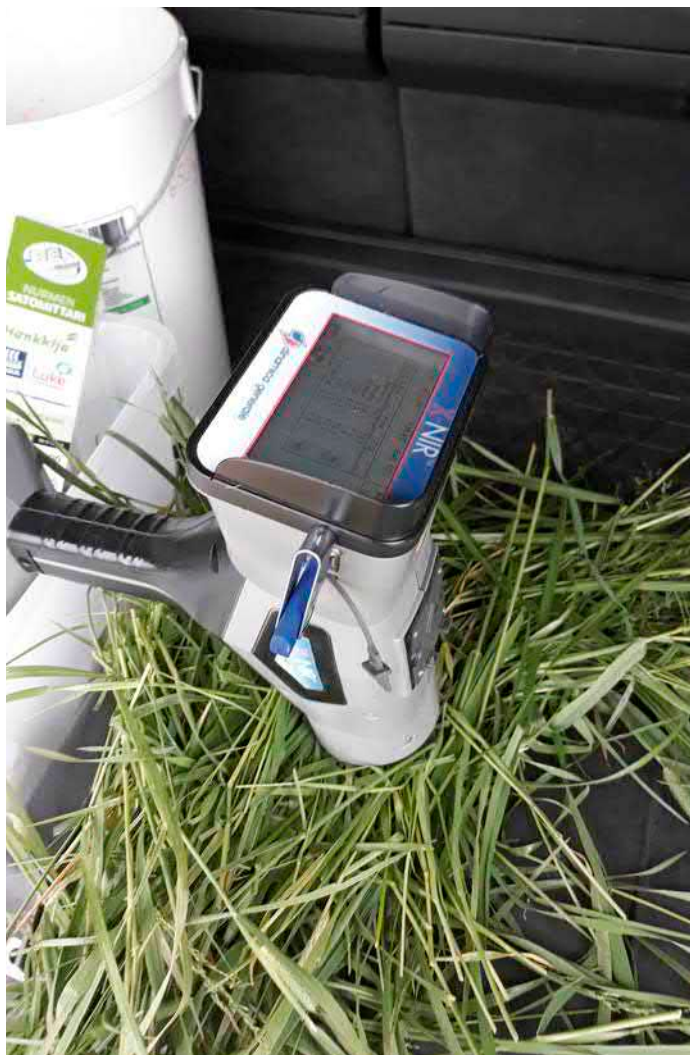
X-NIR on italialaisvalmisteinen, lähi-infrapunaspektroskopiaa hyödyntävä kannettava mittalaite. Laitteella voi mitata pellolla kasvaa nurmea tai jo kerättyä korjuuajanäytettä. Nurmen eri kalibroinneilla pystyy mittaamaan myös kuivaheinää ja säilörehua. Valmistajalla on lisäksi muitakin näytekohtaisia kalibrointeja, joita laitteessa voi kerrallaan olla tallennettuna kolme.
