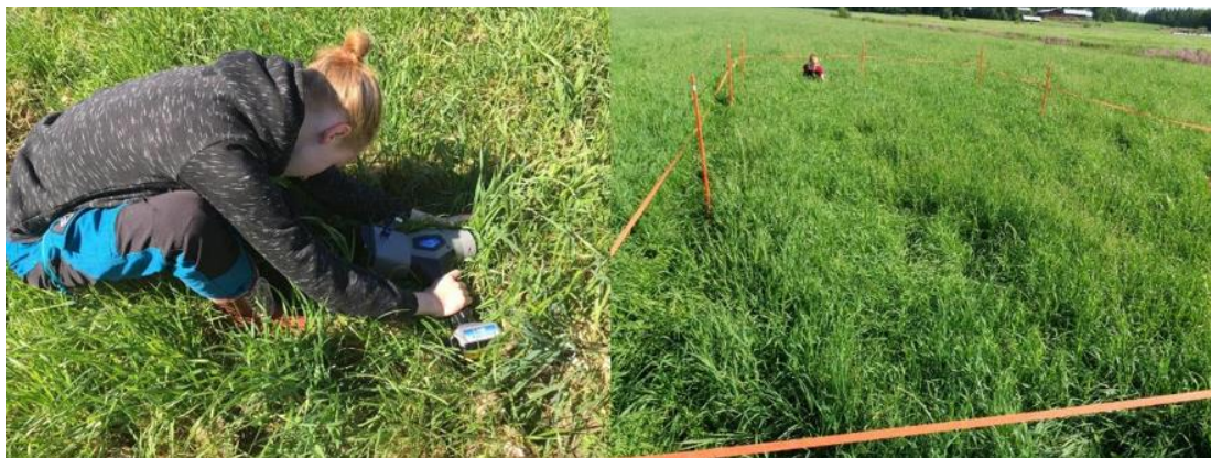
Kuva 8. Vasemmalla kuvassa kasvuston mittausta X-NIR mittalaitteella ja oikealla seuranta-alue merkittynä peltolohkolla. Mittausvaiheessa mitattavan kasvuston takana käytettiin valkoista teflonlevyä vakioimaan heijastukset.
