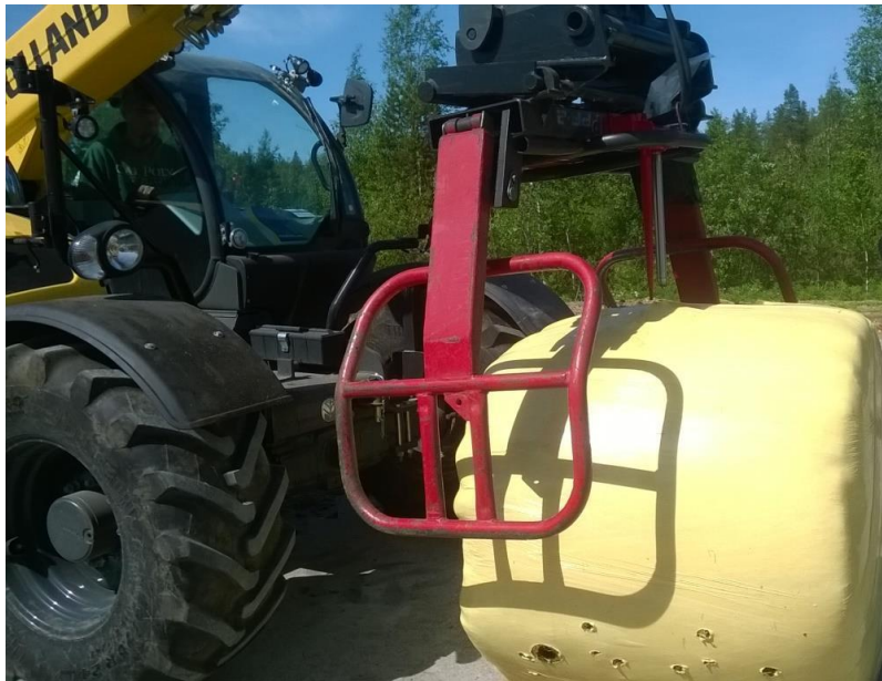
Kuva 4. Paalipihteihin kiinnitetty rehunäytteenotin, jossa teräksisen näyteputken vieressä on punainen tukipiikki estämässä näyteputken vääntymistä näytteenoton aikana.
