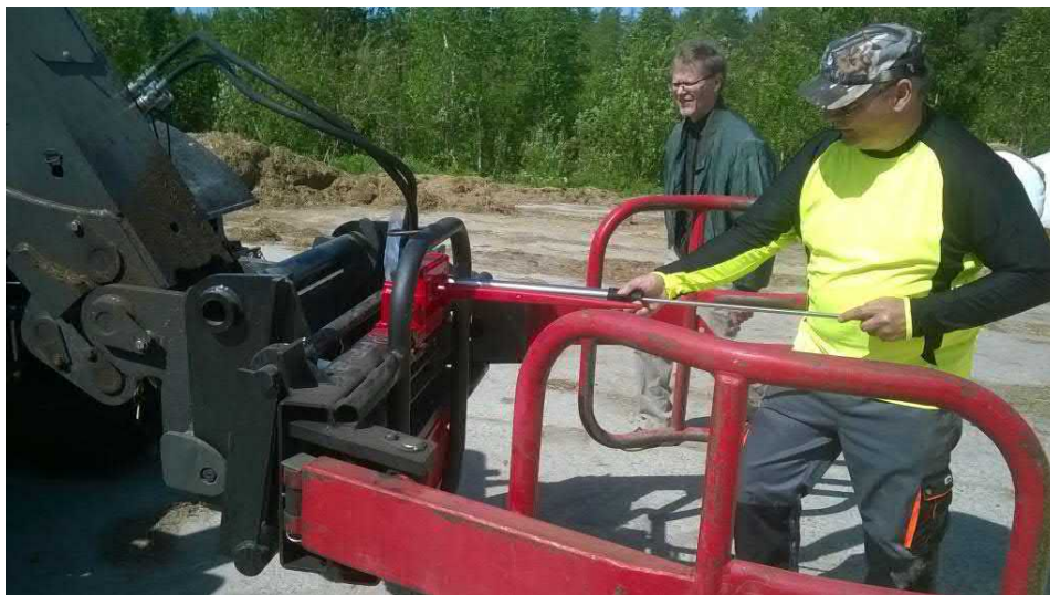
Kuva 6. Näyteputken tyhjennys tyhjennystyökalun avulla näytteenoton jälkeen.
