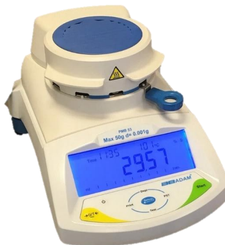
Kuva 5. Hankkeessa kokeiltiin Adam Equipment PMB53 halogeenikuivainta tilalla tehtäviin kuiva-ainemittauksiin. Laite toimii verkkovirralla ja vaatii suojaosan paikan palamattomalla alustalla. Hankkeessa laitteella on mitattu myös ulkona, jolloin tuuli voi haitata vaa'an toimintaa.
