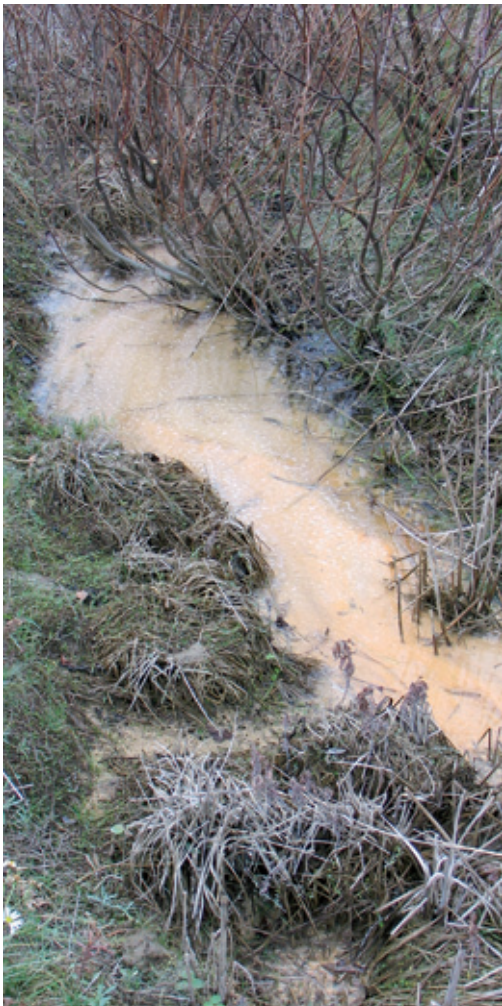
Avo-oja, johon kuivatusvesi virtaa. Rautasaostuma näkyy punaisena ja alumiinisaostuma harmaan-valkoisena.
